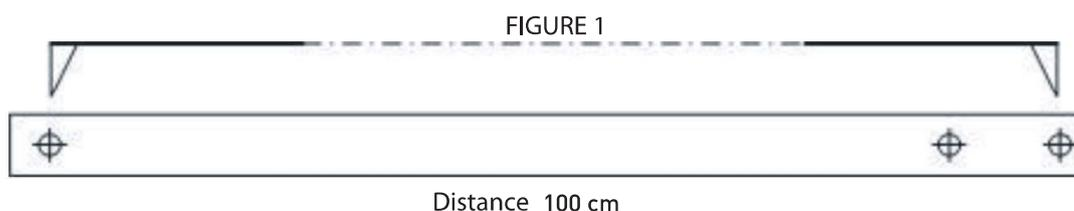
**IMPORTANT: Si la barrière doit suivre le tracé d'une courbe, il faudra ajuster de 5mm environ, en plus ou en moins, cette distance afin d'obtenir une bonne tension du filet (voir les schémas du paragraphe 3 ).**
