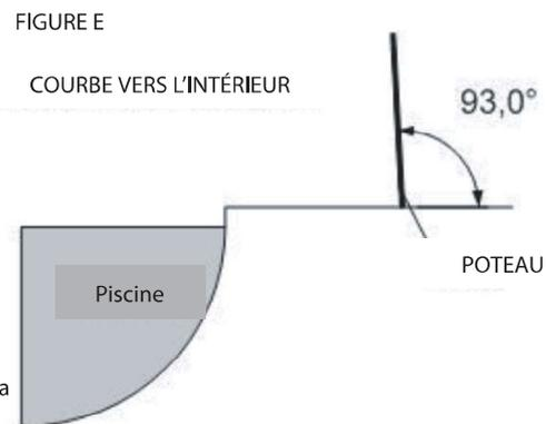
L'inclinaison des poteaux en fonction des courbes permet d'obtenir une tension optimale du filet dans sa partie supérieure.
